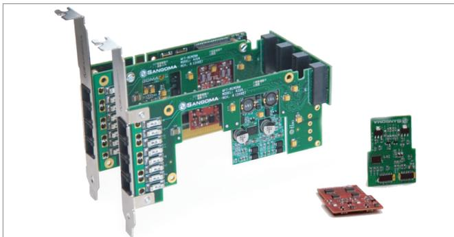
Se pueden montar hasta cinco tarjetas auxiliares Remora™ adicionales en las posiciones de las ranuras vacías junto al ensamblaje de la A200, conectadas mediante un conector de bus de plano de conmutación.
